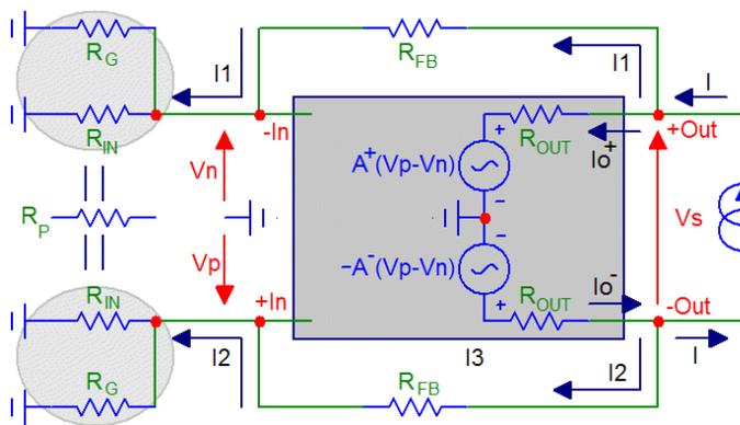
On a repris le schéma équivalent de l'UGS, et on a juste changé un ou deux trucs en passant. Par exemple, on a abandonné les tensions sur chacune des sorties au profit de la tension différentielle  $V_S$ . Les résistances  $R_{OUT}$  qui apparaissent en série avec les générateurs de tension équivalents (Thévenin) de l'UGS sont les deux impédances de sortie asymétriques en boucle
