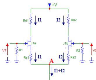
Sur le petit schéma ci-contre, une version épurée de la paire différentielle, amplement suffisante pour comprendre.
