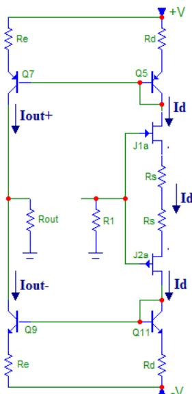
Le courant  $I_D$  est donc fixé par les résistances de source des JFets, et il est le même pour les deux fets J1a et J2a. Si on suppose que tous les transistors bipolaires présentent les mêmes caractéristiques, ils vont réagir de la même façon, et de ce fait les miroirs de courant vont se comporter de manière identique.
