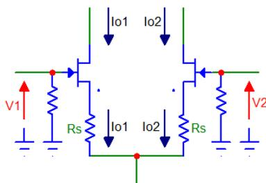
On remplace les JFets par leur modèle équivalent pour finalement arriver au schéma de droite... On a supposé ici que tous les JFets étaient les mêmes (le même  $g_m$  partout) pour pas s'embarlificoter dans les équations.
