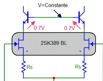
JFets en fonctionnement normal étant relativement faible (bien inférieur au volt), on va donc dire rapidement que la tension  $V_{DS}$  aux bornes des JFets reste stable, ou du moins varie très peu.
