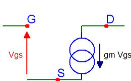
On retrouve les trois connexions Grille/Drain/Source, et le générateur de courant commandé par ta tension grille/source. Ce type de schéma n'est valable qu'avec des signaux variables (alternatifs) de faible amplitude, et présuppose que le circuit est correctement polarisé et tout et tout. Encore une fois,
