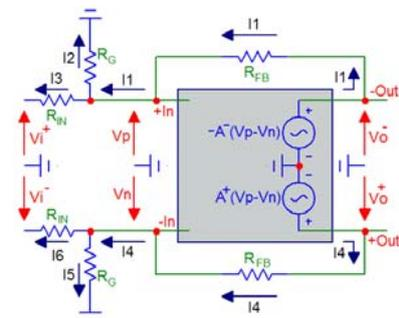
Tout d'abord resituons les choses :  $R_{FB}$  et  $R_{IN}$  sont les résistances de contre-réaction, et  $R_G$  est la résistance de grille des JFets, ( $47K\Omega$  chez nous).  $V_i^+$  et  $V_i^-$  sont nos tensions d'entrée, ce qu'on envoie réellement dans le montage, et  $V_o^+$  et  $V_o^-$  sont naturellement nos tensions de sortie. Petit rappel : aucun courant ne rentre à l'intérieur de l'UGS...
