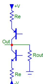
L'impédance de sortie d'un étage à émetteur commun en l'absence de charge est grossièrement donnée par l'inverse de son admittance de sortie  $h_o$ , à savoir :
