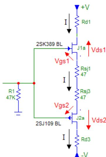
Pour ce qui nous intéresse, c'est équivalent au montage plus complexe. La résistance de source de J2a ( $R_{sj3}$ ) comprend le potar VR2 (sa moitié en fait) et la résistance  $22\Omega$  pour plus de clarté, mais globalement, il faut se dire que toutes les résistances de sources des JFets sont les mêmes.
