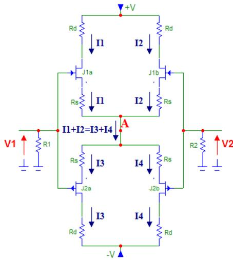
On commence comme d'habitude maintenant par la situation au repos, en l'absence de signal d'entrée ( $V_1=V_2=0$ ).
