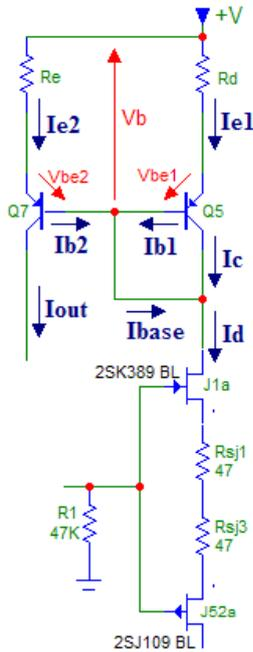
$I_D$  est le courant dans les JFets qu'on vient de calculer si péniblement. Et on va maintenant chercher à comprendre ce qui se passe dans les deux transistors bipolaires...
